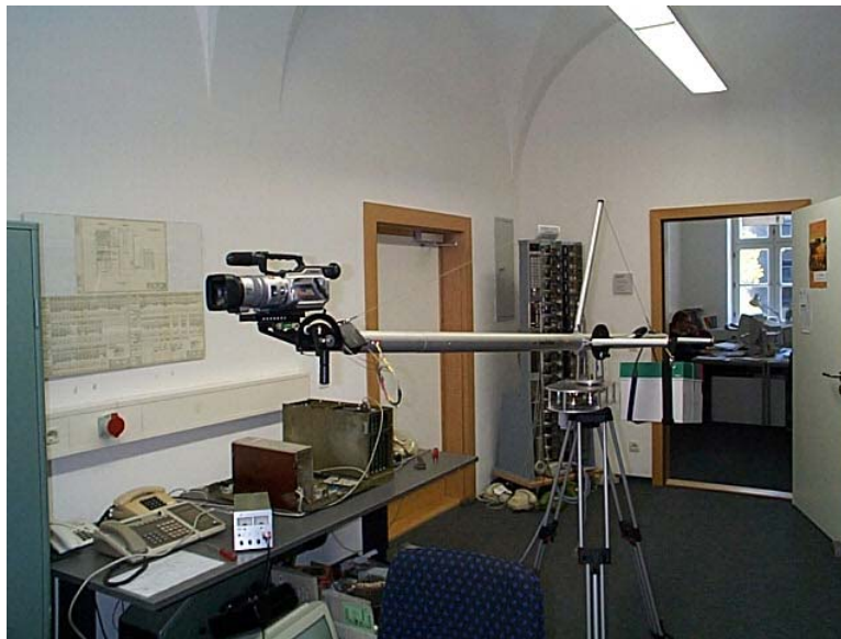
Abbildung 9: An der TU München entwickeltes Akquisitionsgerät für die Plenoptische Funktion einer Szene.
