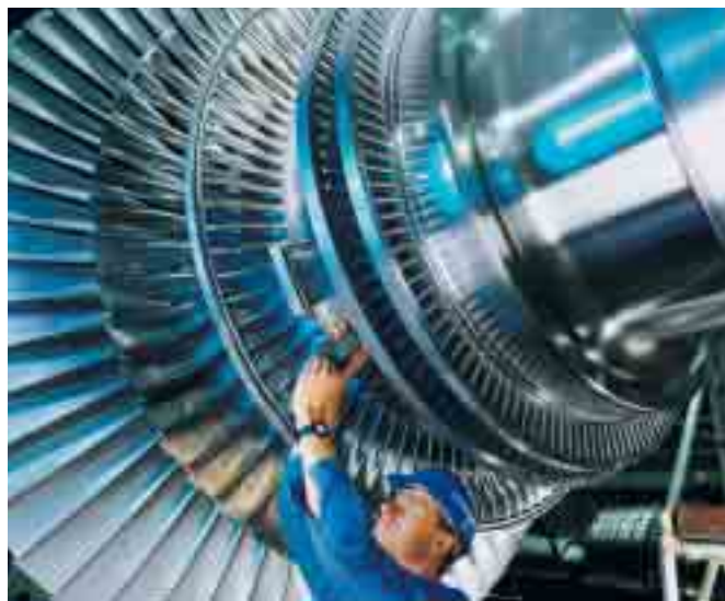
Niederdruck – Dampfturbine, Siemens AG
